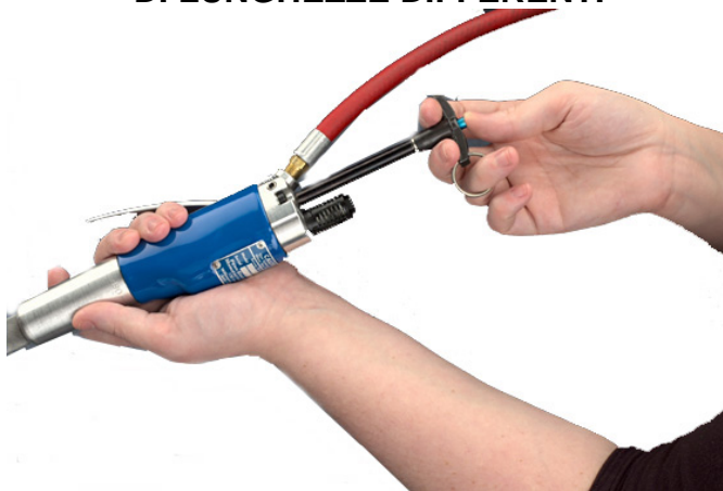
FIGURA 2 REGOLAZIONE DELLA CORSA DELL'UTENSILE PER ELEMENTI DI FISSAGGIO DI LUNGHEZZE DIFFERENTI
