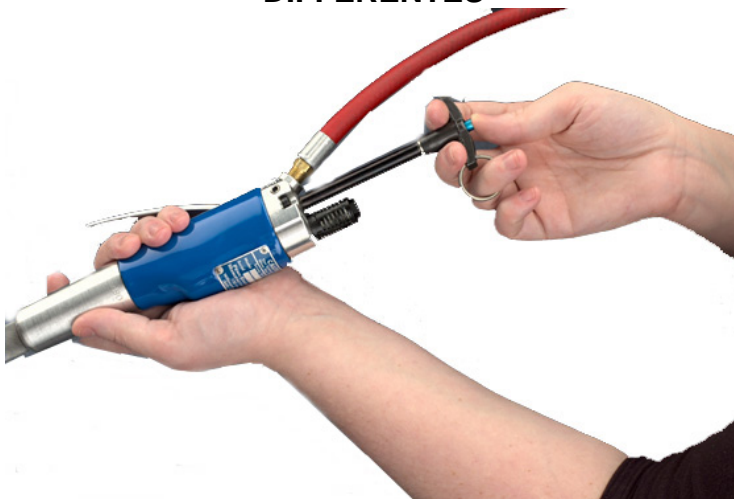
FIGURE 2 RÉGLAGE DE LA COURSE DE L'OUTIL POUR DES ATTACHES DE LONGUEURS DIFFÉRENTES
